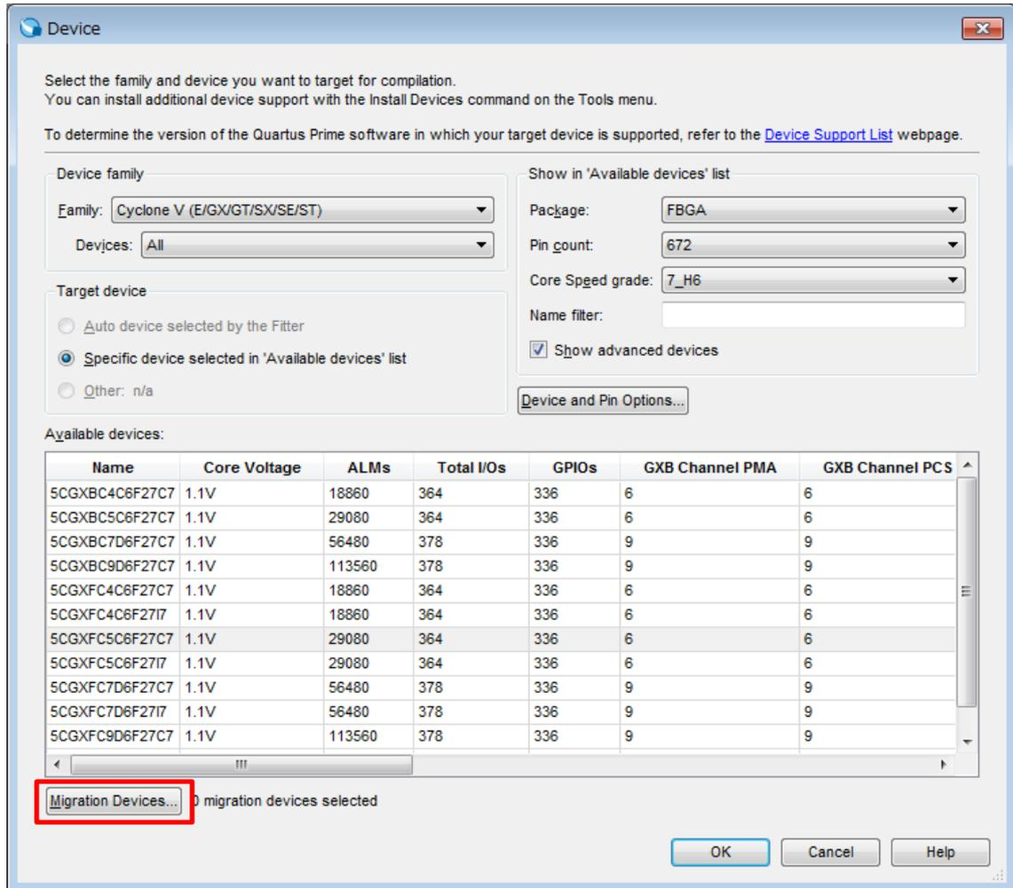
Device ダイアログボックスの左下に位置する “Migration Devices” ボタンは、デバイス・マイグレーション設定のためのボタンです。アルテラ社 FPGA および CPLD の同一デバイス・ファミリ内において、同一パッケージであれば集積度の異なるデバイスに基板改版をすることなく置き換えをすることができ、アルテラではそのことをデバイス・マイグレーションと表現しています。
