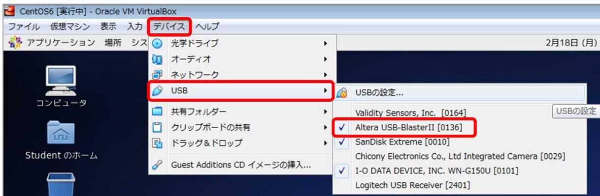
【図 7-6】 Virtual Box の USB 設定から USB-Blaster II の接続を有効にする
